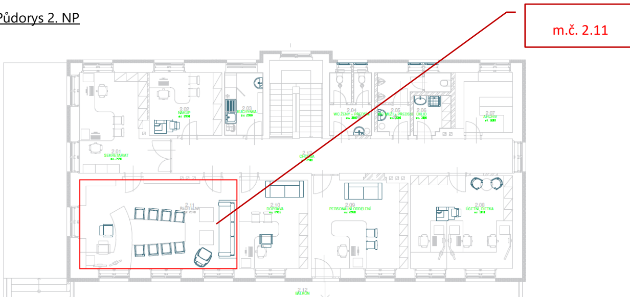
Obr. 4 Schéma půdorysu 1.NP a 2.NP - Výběr kritických místností pro výpočet letní stability.
